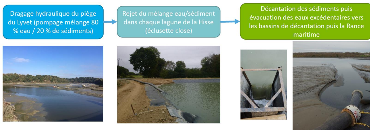
Figure 42 : remplissage successif des lagunes du site de la Hisse par décantation (EPTB Rance Frémur, 2023)
