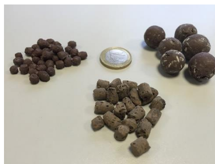
Figure 56 : Coulis autocompactant à gauche (projet SEDIMEL) et granulats légers développés par l'entreprise Alteo environnement Gardanne à droite
