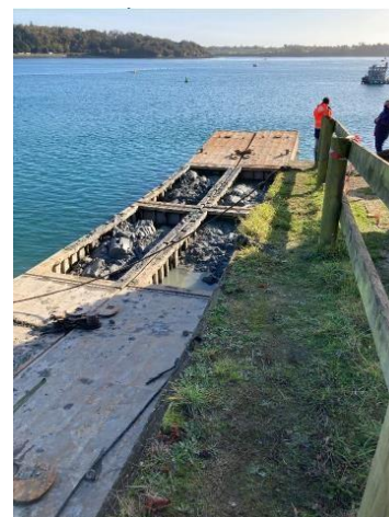
Figure 35 : barges permettant le transport maritime des sédiments avant reprise (EPTB Rance Frémur, 2020)
