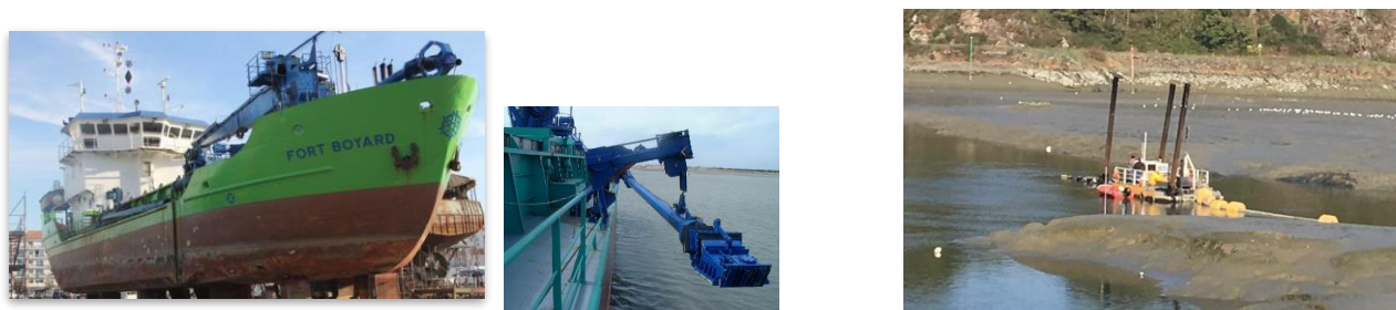
Figure 36 : Drague Aspiratrice en Marche "Fort Boyard" et son élinde (à gauche - Conseil Départemental 17) et Drague Aspiratrice Stationnaire utilisée au niveau du piège du Lyvet (à droite - EPTB Rance Frémur, 2019)
